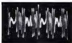
Bild 3. Geringe Intermodulation bei einem guten Tonabnehmersystem
