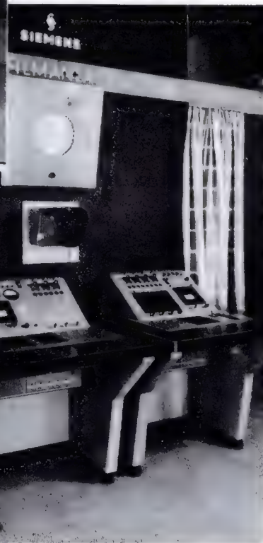
Links: Vierspur-Cinemascope-Mischpult mit Fernsehbeobachtung des Filmstudios
