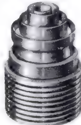
Neue Metall-Keramik-Röhre für den Bereich von 1 bis 2 GHz
